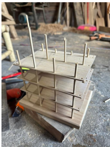
图 7 落地柱传完层、底座的效果
