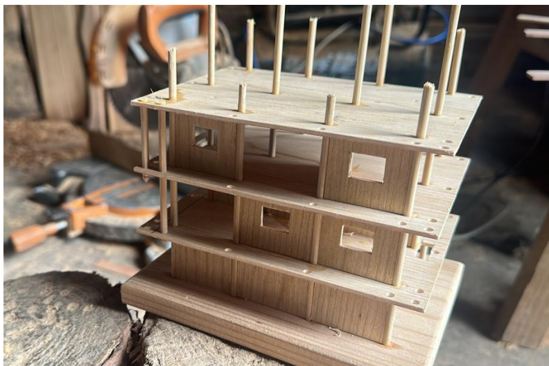
图 14 模型吊柱安装后的效果
