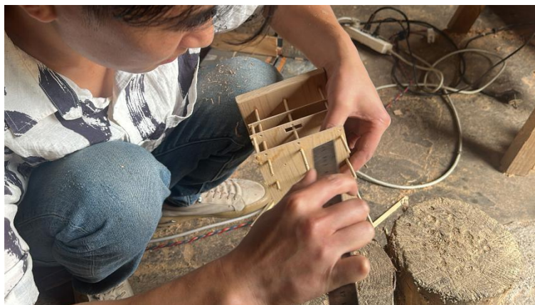
图 18 测量柱子的高度
