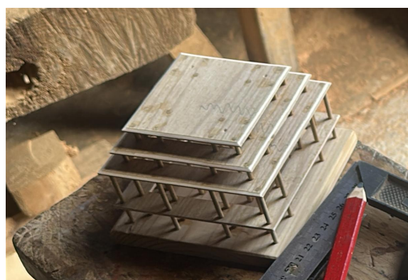
图 37 鼓楼柱、层板安装完成
