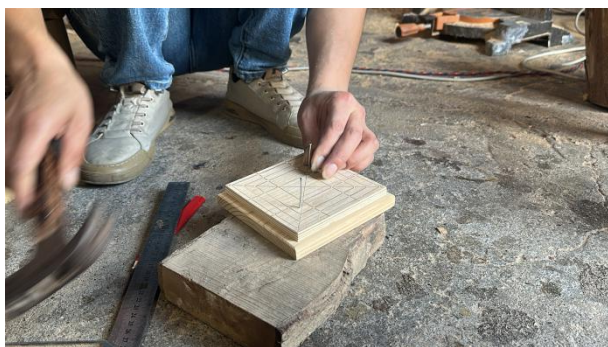
图 32 层板钉在底座上固定
