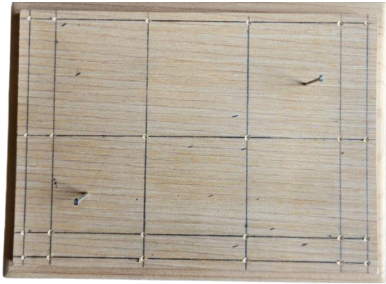
图 2 平面图上交叉点刻浅孔标记
